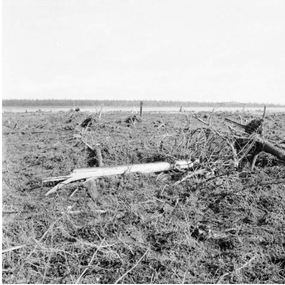
Övre delen av stolpen på 50 m hade kastats 25 m längre bort.
