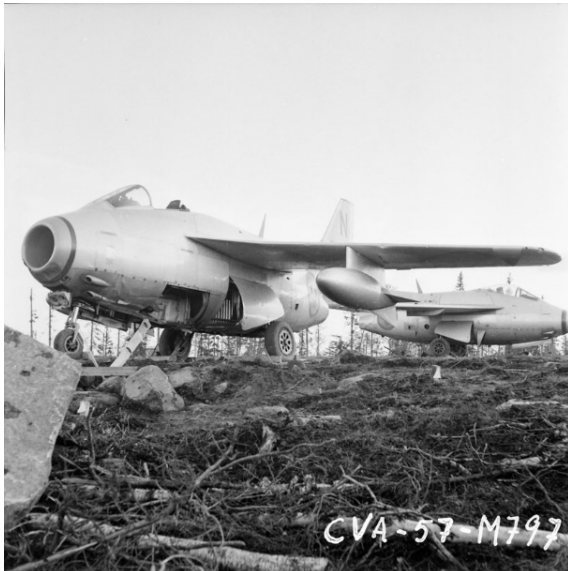
Skadorna på flygplanen var små. Det ena planet var under försöket försett med osäkrade raketer, men dessa utlöstes inte.
