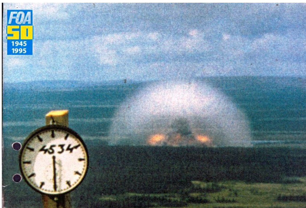
Den 28 augusti 1957. 36 ton sprängämne av typ bonyl exploderar i den lappländska ödemarken. Stötvågen har nått sin undertryckfas och det vatten som finns i luften förvandlas till ånga. Själva stötvågen syns inte och ligger en bra bit utanför vattenkupan
